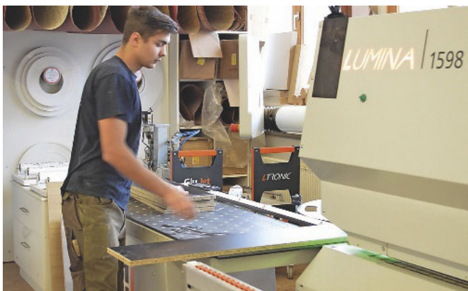
Daniel Werner hat zunächst am Touchscreen das Programm und die Kante gewählt. Jetzt gibt er die Werkstücke in die Maschine ein, ...
