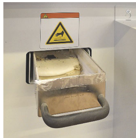
Das Reinigungsprogramm entleert die Düse in diese Schublade hinein
